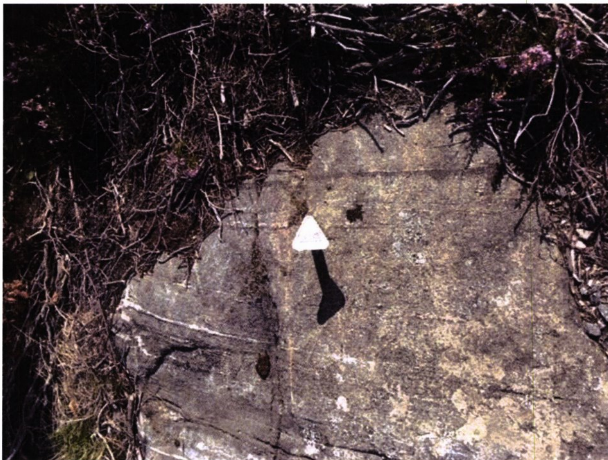
Grensebolt funnet ca. 10 m lengre nord enn grensepunkt i målebrev. Trolig en eldre grensebolt som ikke er fjernet.
