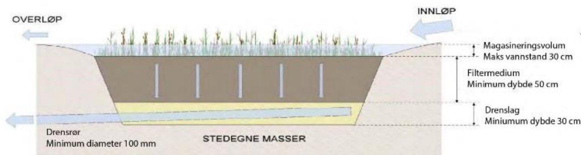
Figur 4, Infiltrasjonsbasseng, Oslo kommune
