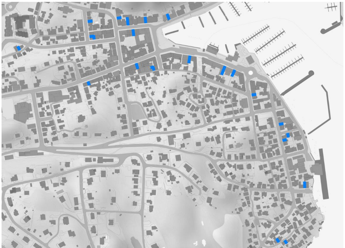
Figur 45: Kartillustrasjon viser anbefalt plassering av fasadesprinkler.
