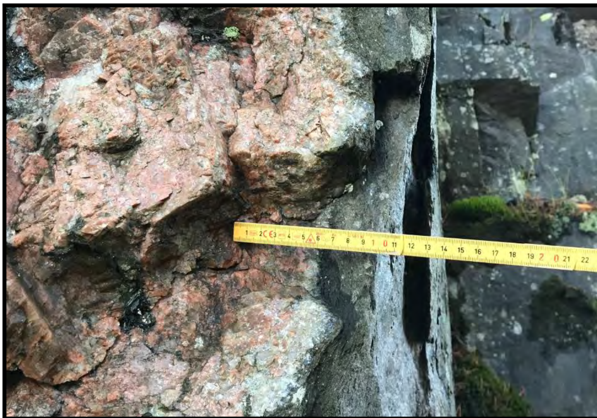
Figur 50. Pegmatittintrusjon som følger sett 1 i eksisterende skjæring. Foliert glimmerlag i ytterkanten, på grensen mot omkringliggende bergarter.
