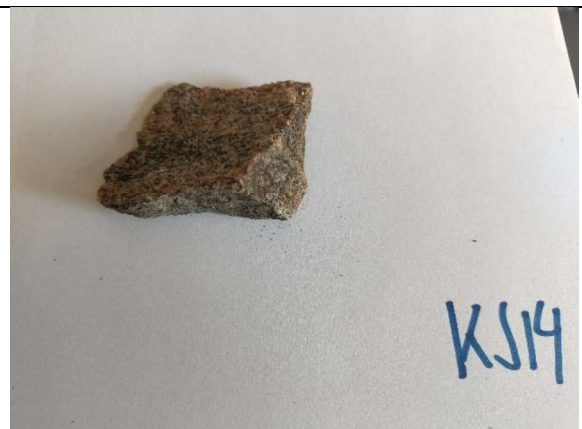
Granittisk gneis, rød feltspat. Lite forvitret, ingen/lite overfladisk rust.
