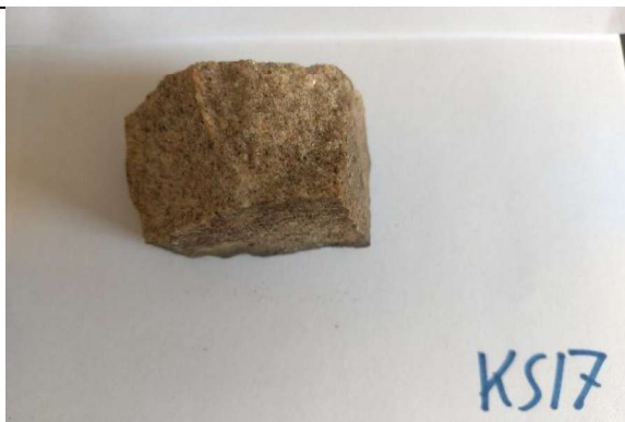
Finkornig feltspatrik gneis - mot syenitt (litt kvarts). Lite forvitret, lett rust et par mm inn i overflaten.
