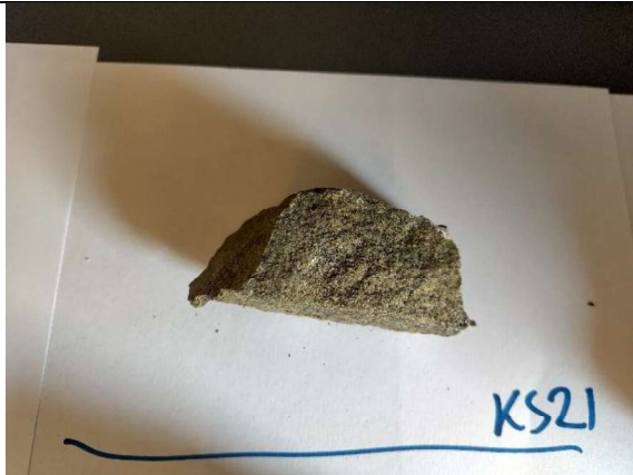
Amfibolitt, feltspatrik. Kun lett forvitret, rust et mm inn i overflate.
