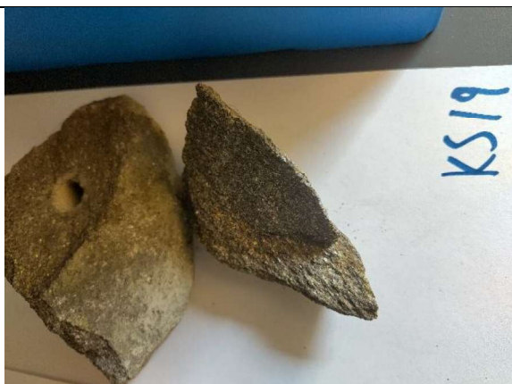
Lite forvitret, ikke synlig rust. Noe lett oppsmuldring øverste mm av overflate.
