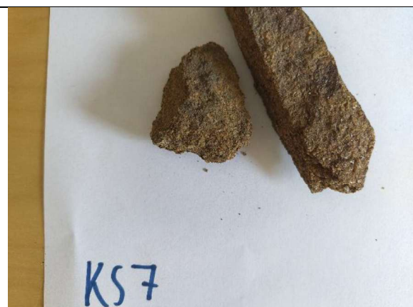
KS7 Glimmergneis. Sterkt forvitret. Oppsmuldret overflate. Rust flere cm. inn i stein.
