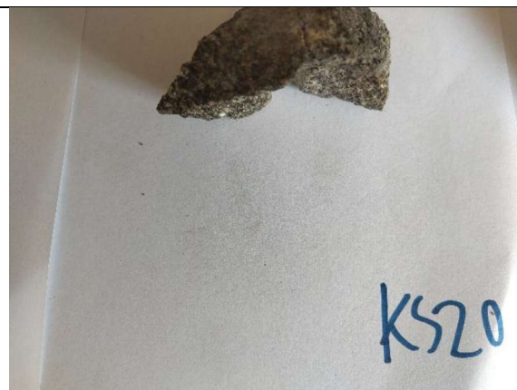
Amfibolitt, feltspatrik. Lite/ingen forvitring. Lett rust noen mm inn i overflaten.
