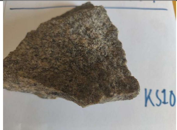
Granittisk gneis. Ingen/lite forvitring. Kun lett rust 1 mm inn i overflate.
