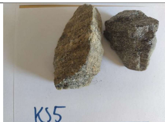
KS5 Granittisk gneis, sterkt foliert. Mye glimmer og noe amfibol. Noe forvitret/ opp-smuldring i plan med skifer. Kun overfladisk rust.
