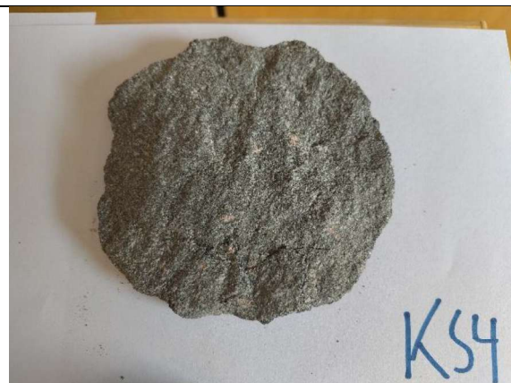
KS4 Granatglimmerskifer. Ingen synlig rust, noe oppsmuldring i overflate.
