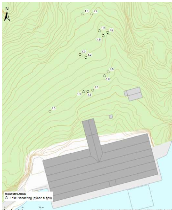
Figur 16 Resultater (dybde til antatt fjell/fast grunn) av COBRA boringer.
