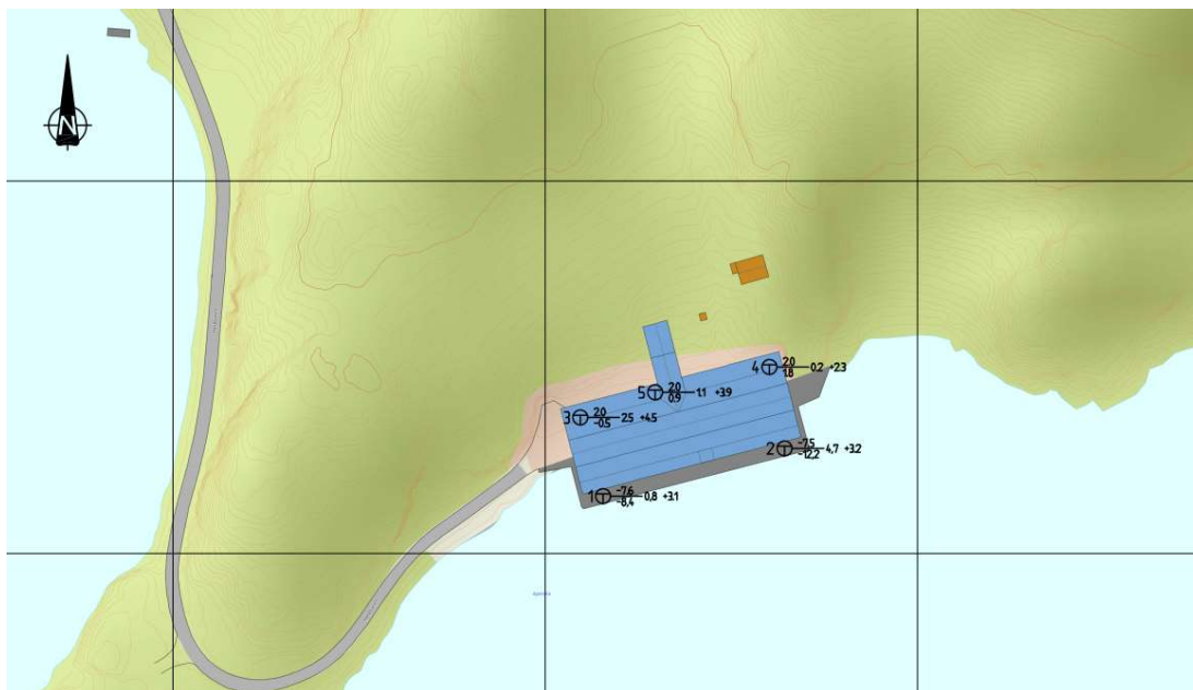
Figur 15 Resultater fra utførte grunnundersøkelser i planområdet av Grunnboring Sør AS /14/.
