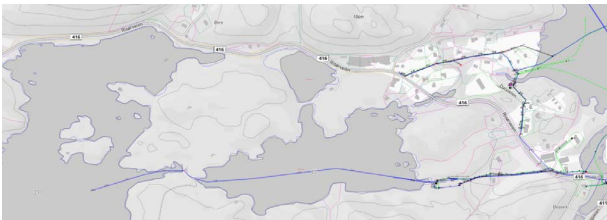
Figur 58: Kart over vann- og avløpsledninger
