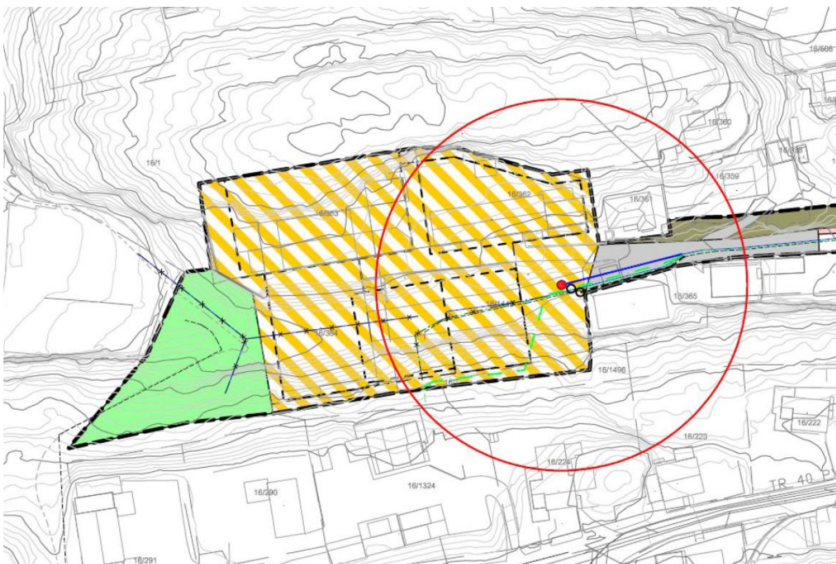
Figur 33 Forslag til ny/omlegging av eksisterende VA. Brannkum er vist med rødt og markert med en sirkel med radius 50m.
